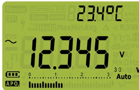
Abbildung 2-1 AC-Spannungsanzeige
