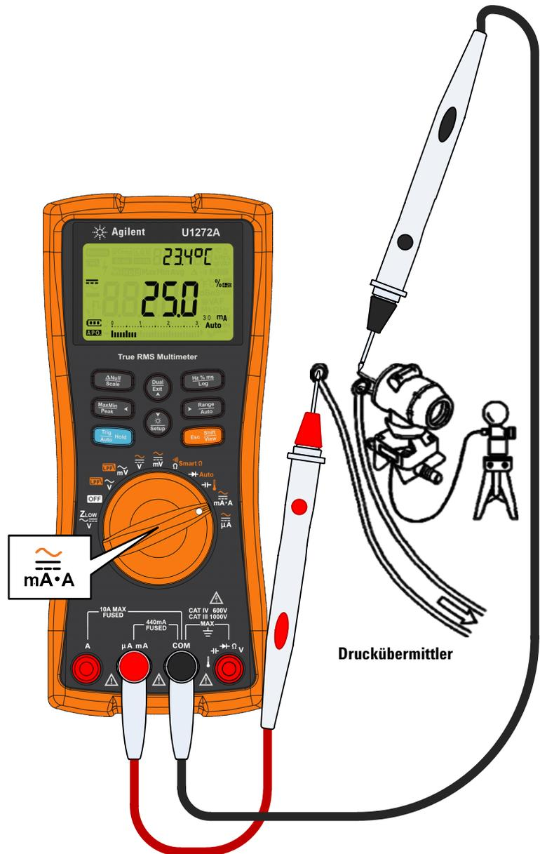
Abbildung 2-34 Messen der DC-Stromstärke mit der Funktion 4-20 mA %-Skala
