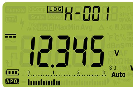
Abbildung 3-7 Anzeige der manuellen Protokollierung
