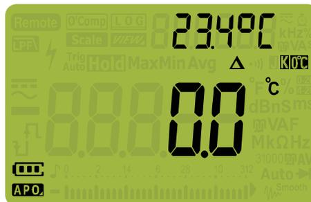
Abbildung 2-28 Temperaturmessungen ohne Umgebungskompensation
