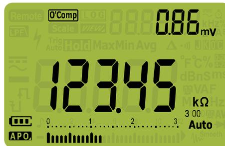
Abbildung 2-16 Anzeige von Smart  $\Omega$  (mit Vorspannung)
