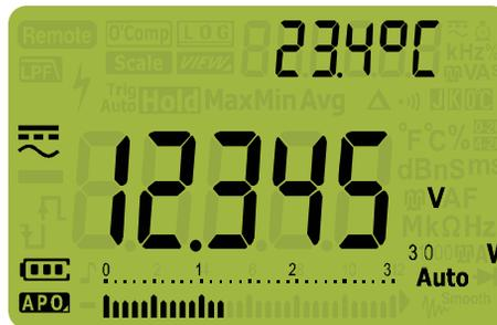
Abbildung 2-7 AC+DC-Spannungsanzeige
