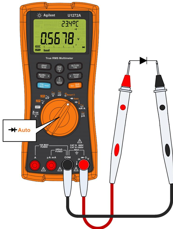
Abbildung 2-20 Testen der Durchlass-Diode
