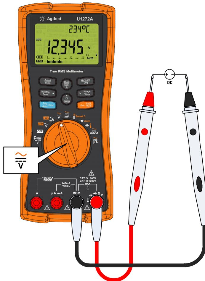
Abbildung 2-6 Messen der DC-Spannung
