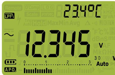
Abbildung 2-3 Ac-Spannung mit LPF-Anzeige
