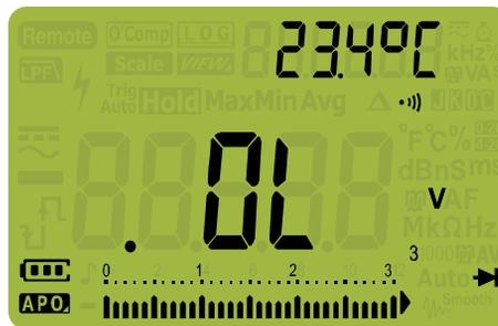
**Abbildung 2-19** Anzeige offener Diode
