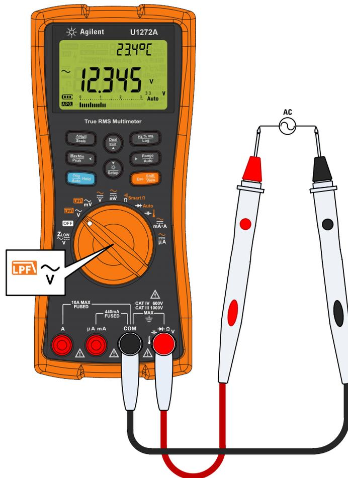
Abbildung 2-2 Messen der AC-Spannung
