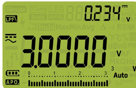
Abbildung 2-4 DC-Kopplung für AC+DC-Spannungsmessungen
