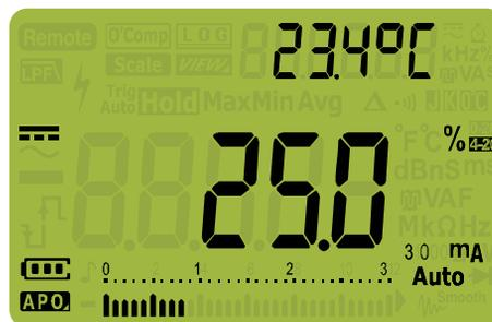
Abbildung 2-33 4-20 mA %-Skalaanzeige
