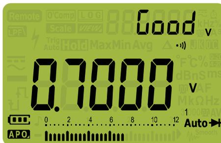
Abbildung 2-22 Anzeige für Autom. Diode - Status "Good"
