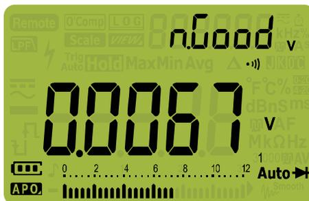
Abbildung 2-23 Anzeige für Autom. Diode - Status "nGood"
